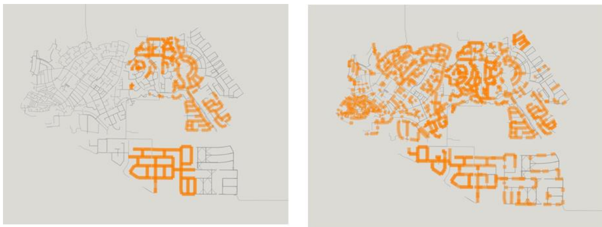
Figuur 4 onderheid (links) versus hoekverdraaiing klasse 4 en 5 (rechts)
