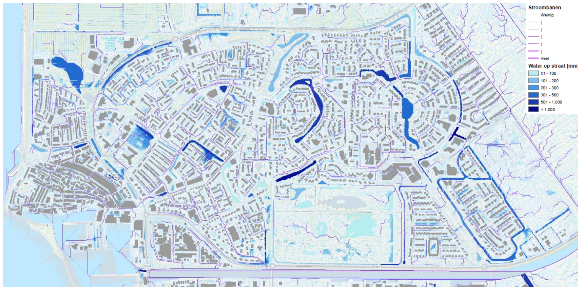
Figuur 10: Berekende water op straat locaties WOLK, bui 60 mm in 1 uur (bron: Effecten afkoppelen kernen Noordoostpolder, Tauw 6 maart 2017, bijlage 1)
