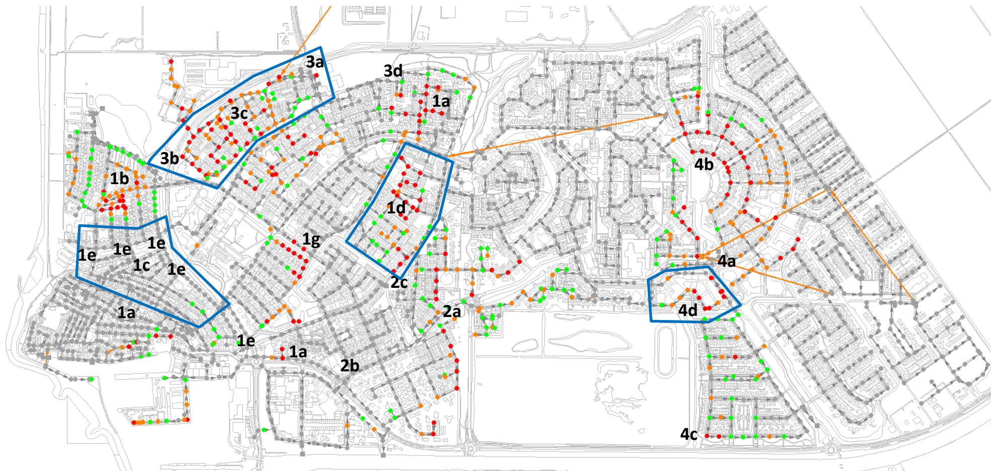
Figuur 12: Voorgestelde maatregelen gemengde stelsel Urk
